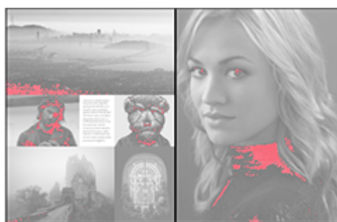
Vista de separaciones (lo que supera el límite máximo de tinta se ve en rojo)
