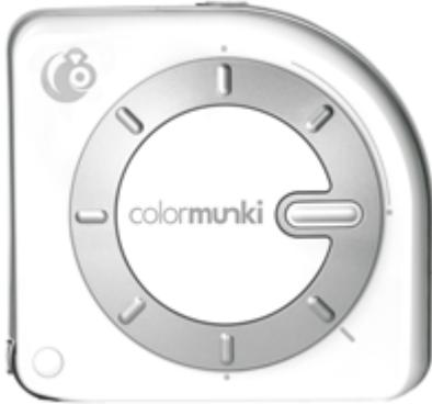
Ya hemos visto [cómo se calibra una pantalla](#) con el espectrofotómetro Color Munki. Ahora veremos el método para calibrar una impresora con ese mismo dispositivo. Si calibrar una pantalla con este aparato era sencillo, fabricar con él el perfil de una impresora con un papel y tintas determinadas no es mucho más complicado.
