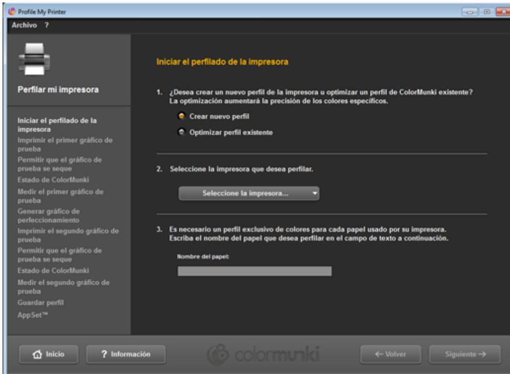
A continuación, seleccionamos la impresora del sistema que queremos calibrar. Los controladores de la impresora tienen que estar instalados en el sistema y ésta tiene que estar disponible. De no ser así, es imposible continuar el proceso. Esto tiene que ver con el hecho de que no es posible realizar calibraciones independientes y remotas con ColorMunki.
