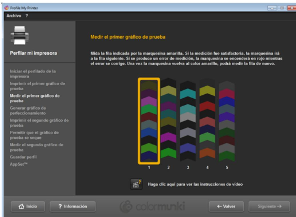
Una vez autocalibrado, aparece un aviso en la pantalla para que midamos la primera línea del lote de parches. Nos indica con un rectángulo amarillo cuál debemos medir y en qué posición debemos colocarlo. Es importante no equivocarse y colocarlos al revés.
