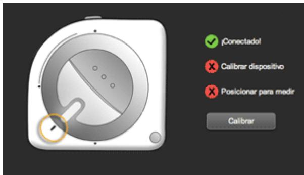
Lo siguiente es preparar el calibrador para hacer las mediciones. Como es un espectrofotómetro, ColorMunki necesita autocalibrarse cada vez que inicia una sesión. Eso lo hace cuando colocamos sus controles en una posición determinada y el programa nos avisa en todo momento de los pasos que tenemos que dar.
