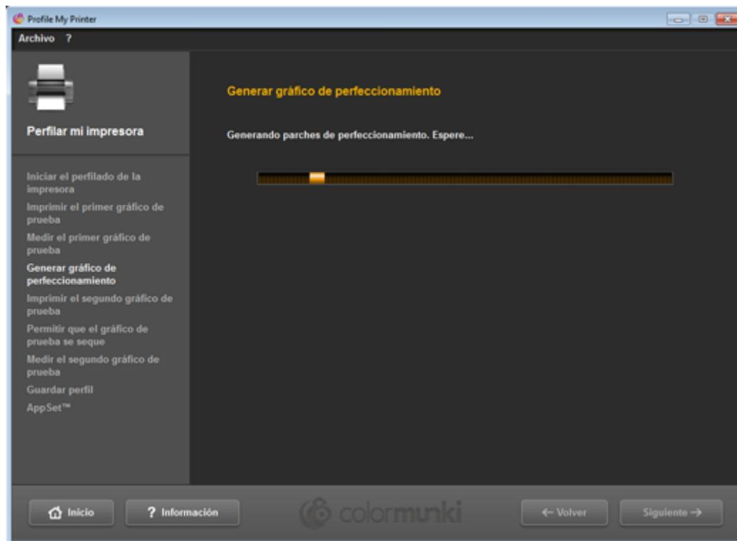
A partir de esas mediciones, el programa comenzará a calcular los valores necesarios para el segundo lote de parches. Este cálculo es otra de las razones por la que ColorMunki no se puede usar para mediciones remotas, por cierto. La idea es que ColorMunki usa muy pocos parches para las mediciones en comparación con otros calibradores debido a este proceso de cálculo que, supuestamente, optimiza los parches necesarios.
