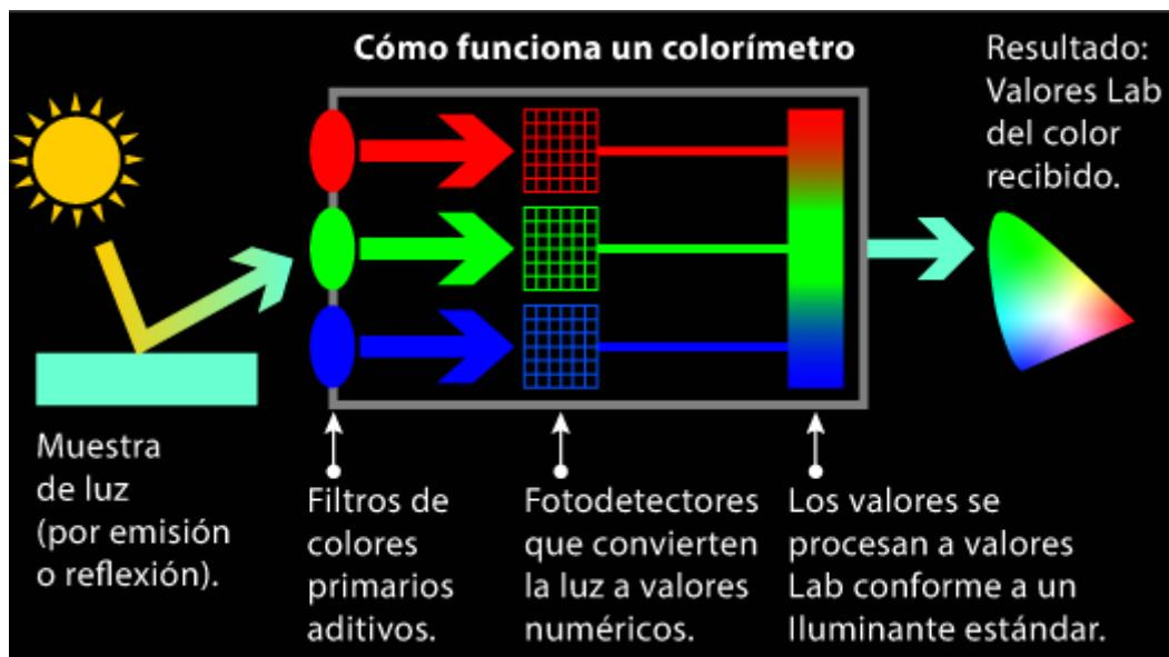
Los colorímetros miden [valores triestímulos](#) más directamente que los espectrofotómetros y funcionan basándose en filtros de color. Por eso, los colorímetros no proporcionan datos de reflectancia espectral.
