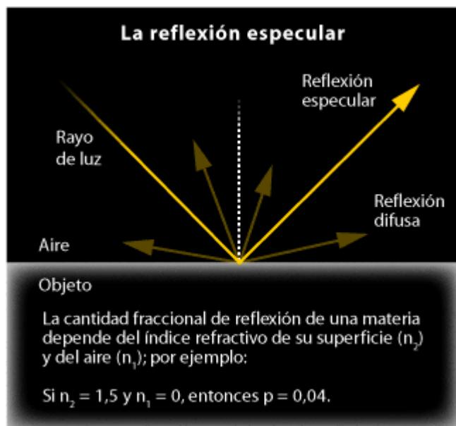
Sin embargo, debido al cambio entre el índice refractivo del aire y el de la mayoría de las sustancias, parte de la luz incidente se ve reflejada por la superficie. La distribución angular de esta luz depende de la naturaleza de esa superficie, pero la luz que se refleja en un ángulo opuesto al de la luz incidente se llama reflectancia especular (*specular reflectance*). La luz que sale reflejada por la sustancia en si se llama reflectancia corporal (*body reflectance*).
