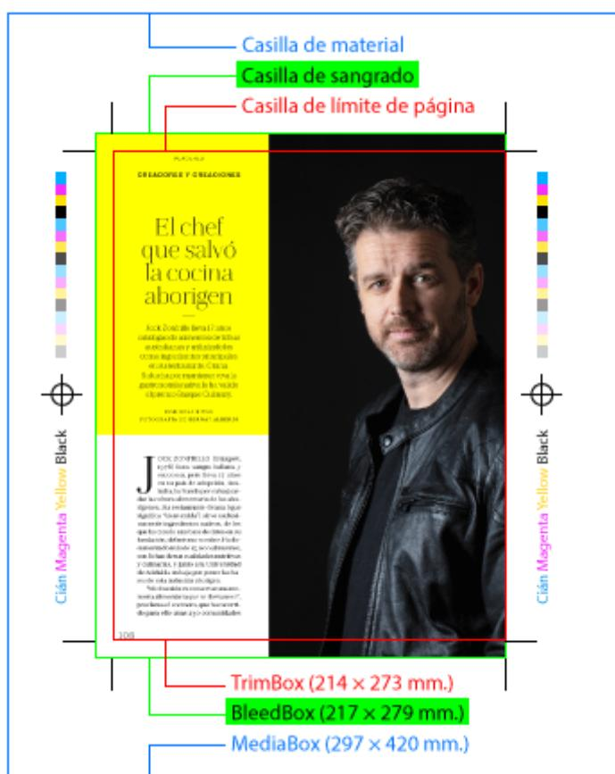
En un ejemplo concreto: Una publicación tiene páginas de  $214 \times 273$  mm: Su *TrimBox* es de  $214 \times 273$  mm. Como tiene 3 mm. de sangre, su *BleedBox* es de  $217 \times 279$  mm. Si se ha colocado en un A3, el *MediaBox* medirá  $297 \times 420$  mm. No tiene porque tener *ArtBox*, pero lo usual es que —salvo que haya una necesidad concreta— ésta mida igual que el *TrimBox*.
