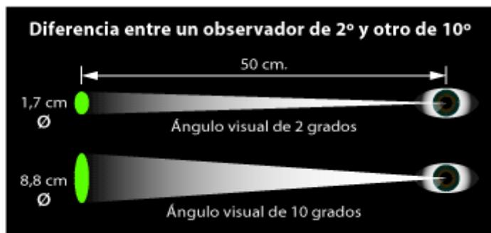
Como los datos de dos grados aun se usan, se suele hacer referencia a los datos de diez grados acompañándolos de un subíndice "10". Así se dice:  $x$ ,  $y$  y  $z$  para los de 1931; y  $x_{10}$ ,  $y_{10}$  y  $z_{10}$  para los de 1964.
