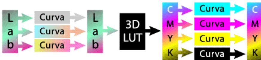
La estructura del perfil de un dispositivo de impresión CMYK.
