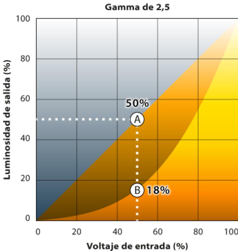
Un TRC con una *gamma* de 2,5 tiene una respuesta como la que se ve en la imagen superior. Observese la diferencia que existe entre el 50% en una progresión lineal (punto A) y el punto equivalente (B) en la progresión hecha con la fórmula  $\text{Luz} = (\text{Voltaje})^{2,5}$ , que da como resultado un 18%. El efecto de la *gamma* del TRC es oscurecer los medios tonos con relación a las zonas de luces y sombras. Un voltaje de entrada del 50% produce sólo una intensidad luminosa del 18%.
