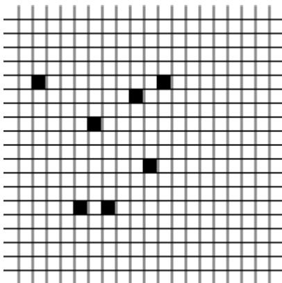
En la imagen superior vemos un ejemplo: Siete puntos de impresión dentro de una retícula de  $20 \times 20$  puntos de impresión. Si esta retícula tuviera 1 pulgada de lado, la resolución del aparato sería de 20 puntos por pulgada.
