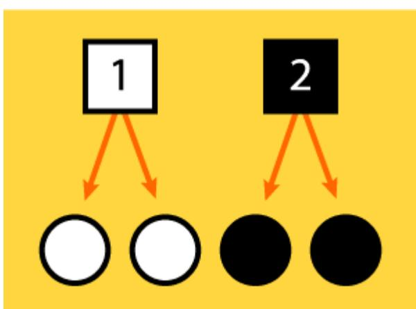
En el mundo real, los problemas empiezan a aparecer cuando para formar nuestros puntos de semitono no tenemos al menos esa relación de un píxel por punto de trama. Si falta información, la máquina la repite. Es la llamada "pixelización": El uso de un mismo pixel para dos puntos (o más) de semitono.
