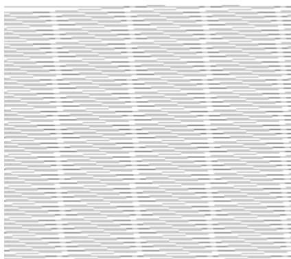
Un caso de muaré: La superposición de líneas negras horizontales y en ángulo de 15º producen la aparición de unas aguas verticales no deseadas.
