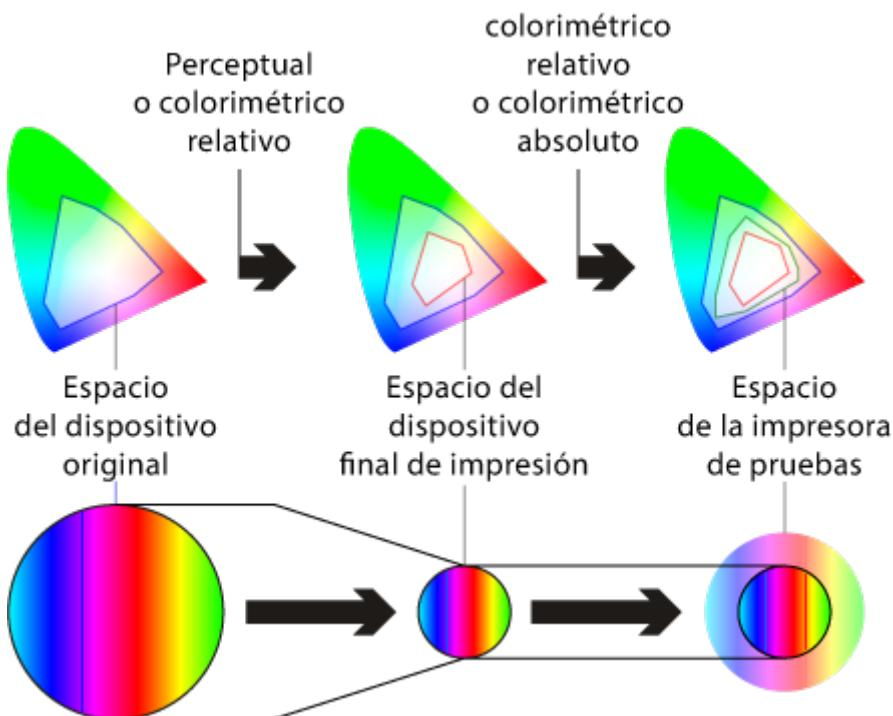
Esquema general de una prueba de color desde el punto de vista de los gamuts de los periféricos involucrados y de los propósitos de conversión aplicados. Cada círculo simboliza el gamut de un dispositivo.
