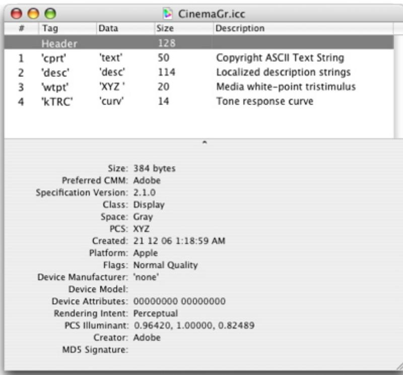
El nuevo perfil tiene una cabecera como la que se ve en la imagen superior. Se trata de un perfil de visualización (*display*) que va de escala de grises a Y. Aquí debajo podemos ver la imagen de la curva de tipo *gamma*.
