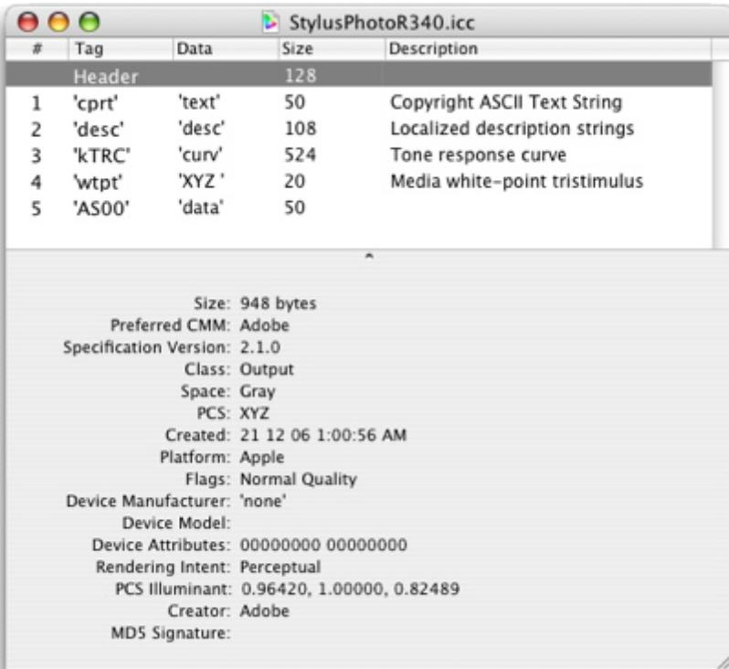
Photoshop guarda el perfil (del que vemos la cabecera en la imagen de arriba) con una curva de 256 puntos (en la imagen inferior). Se trata de un perfil de salida (*output*) que va de escala de grises a XYZ (en realidad sólo a Y, el valor que indica la luminancia relativa).
