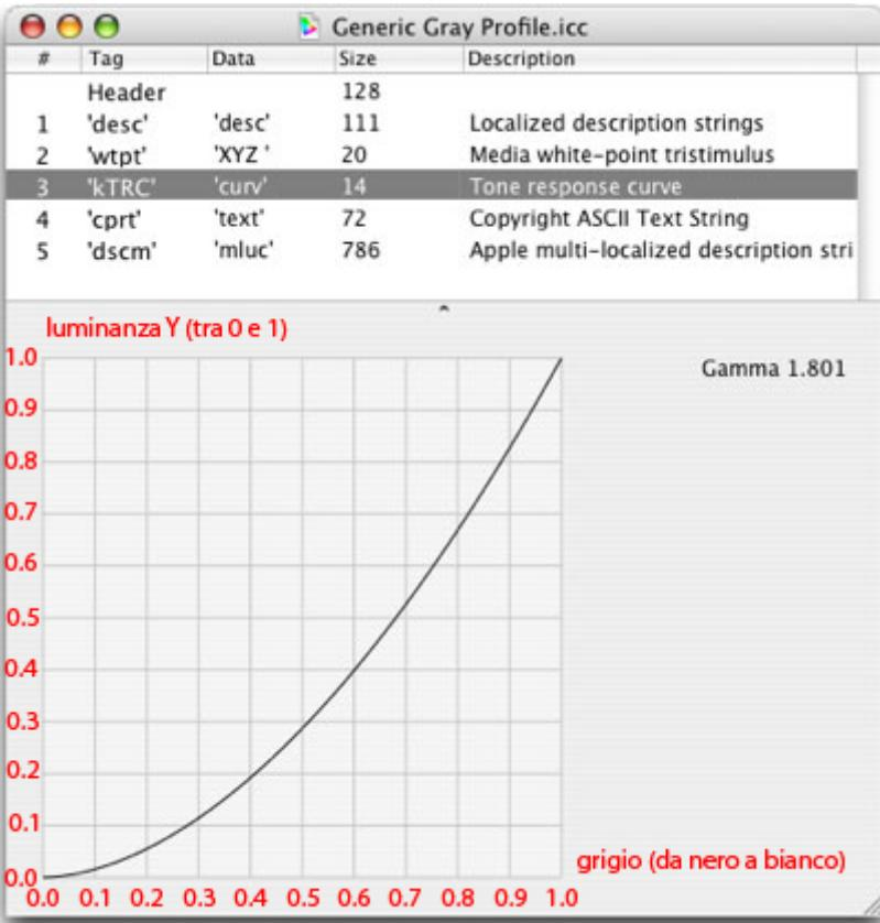
Un perfil de escala de grises de la clase visualización (`display: mntr`), que vaya de escala de grises a Y (luminancia relativa), con una curva de tipo *gamma* tiene una lectura es bastante sencilla. La curva indica directamente la luminancia relativa que produce un píxel de un valor gris determinado. En el perfil "Generic Gray" de Apple (que vemos representado en la imagen superior), por ejemplo, el valor de gris del "0,5" produce "Y = 0,287".
