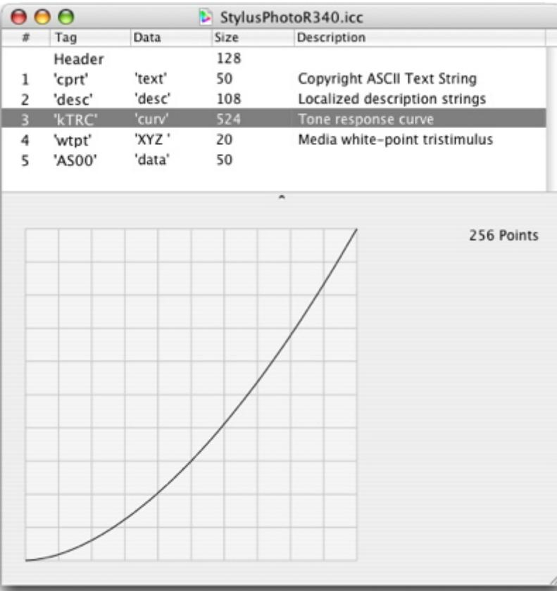
Otra forma de crear un perfil de escala de grises del tipo "ganancia de punto" (dot gain) en Photoshop es partir de los valores del negro de un perfil CMYK ya existente, por ejemplo "Euroescale Coated v2".
