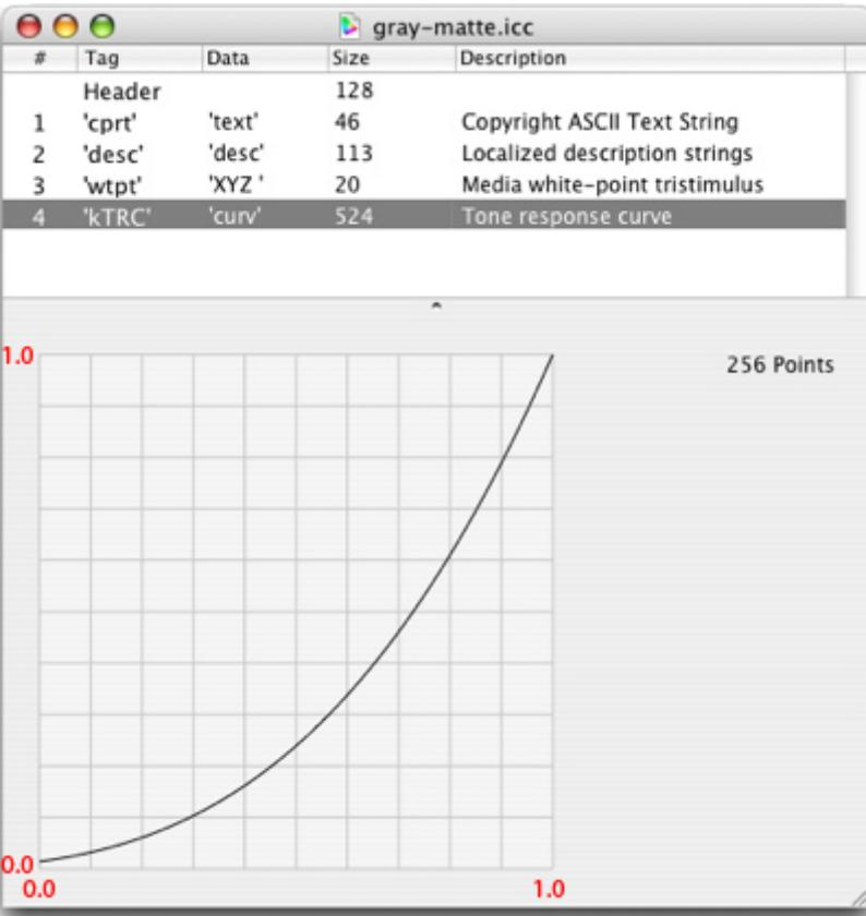
Tomemos, por ejemplo la curva kTRC del mencionado perfil "Gray-Matte" (perfil de salida de escala de grises a Y), que vemos aqui arriba.
