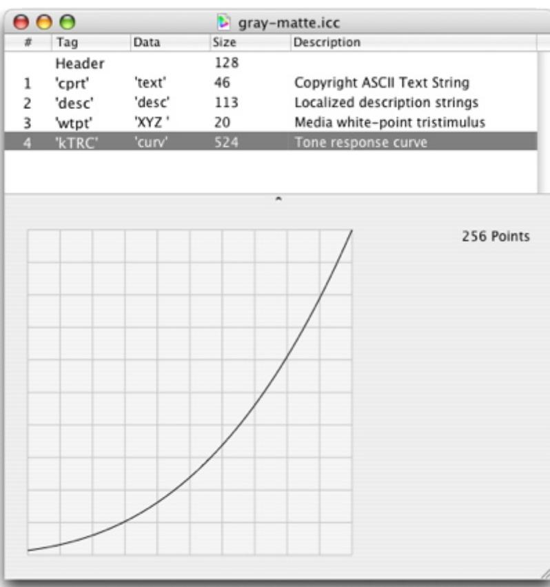
Pie: La curva kTRC del perfil "Gray-Matte", un perfil de salida de escala de grises a Y. Las abcisas y ordenadas van de "0" a "1".
