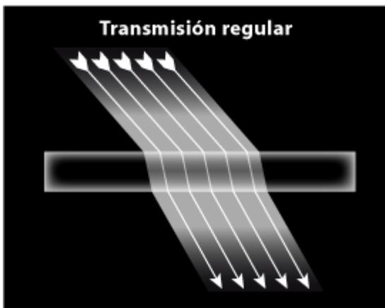
Transmisión regular o especular (*regular transmittance*): Cuando sigue las leyes de refracción y no hay difusión.
