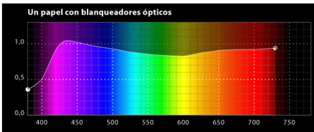
En este gráfico se observa la distribución espectral del factor de radiancia de un papel que contiene blanqueadores ópticos fluorescentes (*optical brightening agents, optical brighteners, fluorescent whitening agents*).
