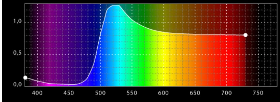
En el gráfico superior, se muestra un tejido con un colorante fluorescente (*fluorescent dye*) que absorbe la energía en la región del azul y la remite en la región del verde, donde se ve un pico (con un valor superior a 1).
