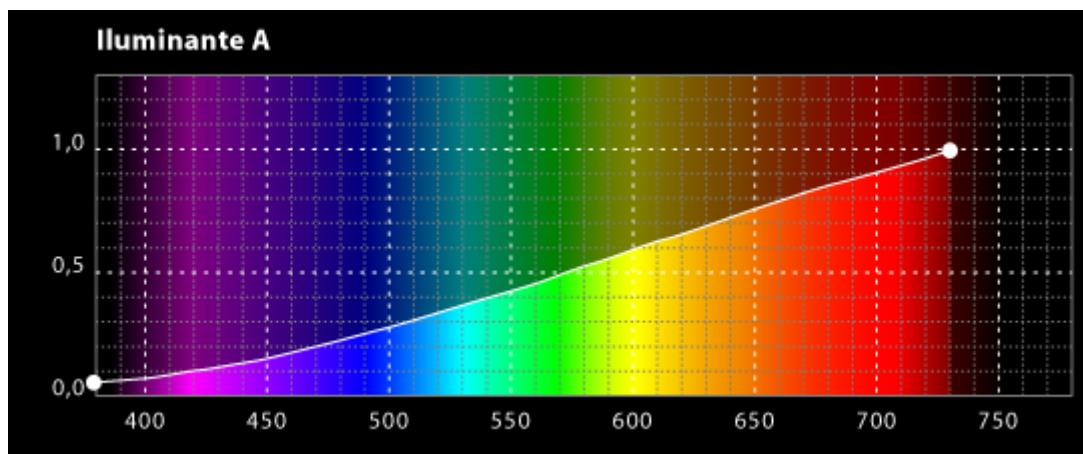
El iluminante A se basa en la fuente más usual de luz artificial: La bombilla incandescente de filamento de tungsteno. Su distribución espectral se corresponde con la de un cuerpo negro a unos 2.856 K.
