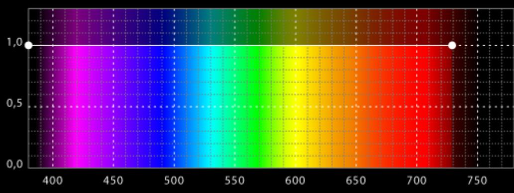
El iluminante estándar E es equienergético (tiene la misma potencia en todas las longitudes de onda del espectro luminoso). Es un iluminante teórico que se usa para cálculos colorimétricos.
