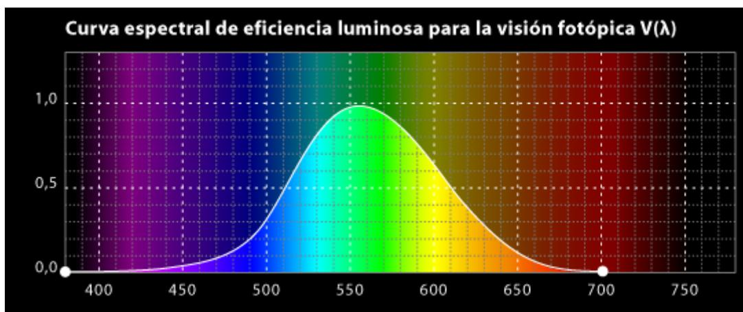
Diagrama de la curva espectral de eficiencia luminosa para la visión fotópica ( $V(\lambda)$ ). En esta curva se describe la sensibilidad luminosa espectral del observador fotométrico estándar definido por la CIE. Esta curva es la que menciono en mi PDF sobre el color como curva conjunta de la sensibilidad de los conos.
