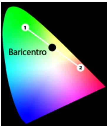
En el diagrama de cromaticidad, la mezcla o síntesis aditiva de dos colores se halla sobre la línea recta que los úne. Aquí funciona la ley del baricentro: Si se considera como peso la luminancia de los dos colores que se mezclan, el resultado de la mezcla está en el baricentro de ambos pesos.
