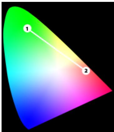
Si dos estímulos de color (1 y 2), representados por dos triestímulos, se mezclan aditivamente, las mezclas resultantes se sitúan sobre una línea recta que une sus dos puntos de situación en el espacio del triestímulo xyz. En el diagrama de cromaticidad, esa misma línea recta une los dos puntos que representan la cromaticidad de ambos colores.
