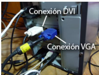
Se conectan ambos monitores al ordenador y a la red eléctrica. Si sólo hay en el ordenador una salida de tipo DVI (que ofrece mejor calidad que las conexiones tradicionales VGA), usaremos esa salida para el monitor principal y dejaremos la salida VGA para el monitor secundario. En mi caso, como el monitor Philips no tiene DVI, no había mucho que decidir.
